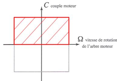
Ce hacheur est réversible en tension et permet d'inverser le sens de rotation du moteur (montée et descente). Par contre, il ne permet de freiner le plateau pendant la phase de descente puisqu'il est irréversible en courant.
