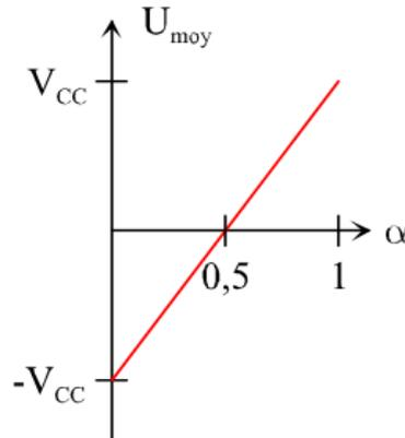
**Question 6 :** Commande MLI (PWM). La fonction « distribuer » est capable d’obtenir une vitesse variable dans les deux sens du siège.
