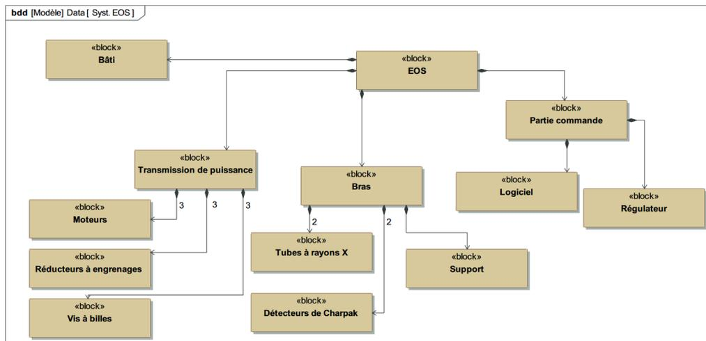
Figure 6 – Diagramme de définition de blocs
